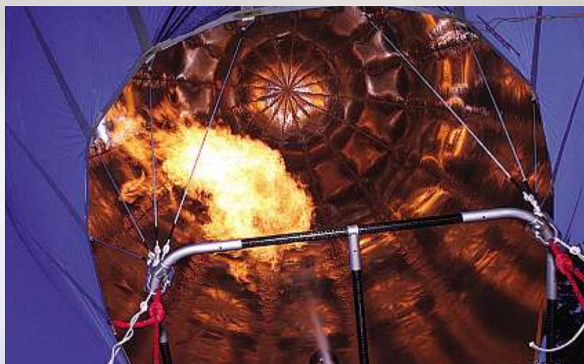
Der Flüsterbrenner - einer von drei Spezialbrennern
